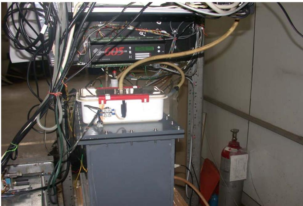
Foto 5.3: Vista del primo comparto anaerobico, misuratore di gas e datalogger.
