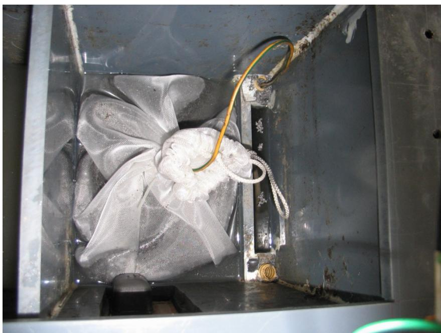
*Fotografia 5.7 Vista dall'alto della seconda camera anaerobica con la grafite granulare già posizionata.*
