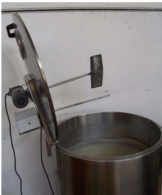
*Fotografia 5.8 Refrigeratore di tipo industriale con sonda di temperatura e miscelatore*
