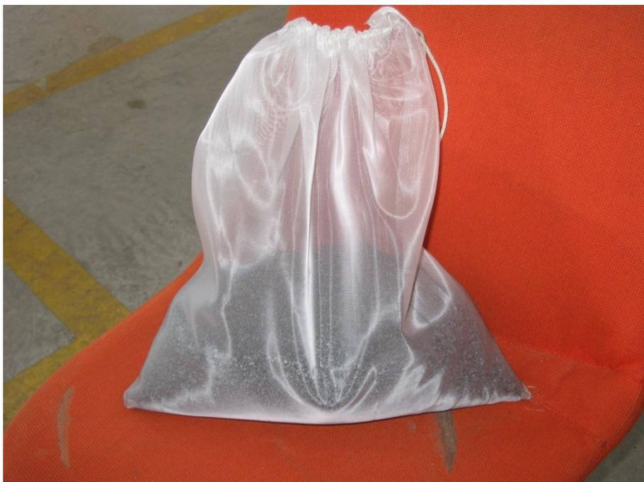
*Foto 5.5 Una delle due reti di contenimento per la grafite granulare utilizzate durante la Fase V di sperimentazione, all'interno della quale è stato inserito un elettrodo in grafite vetrosa.*
