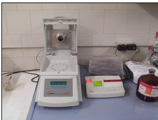
Figura 5.9 Strumenti per la determinazione del COD: a sinistra il termostato per la digestione del campione; a destra lo strumento per la lettura.
